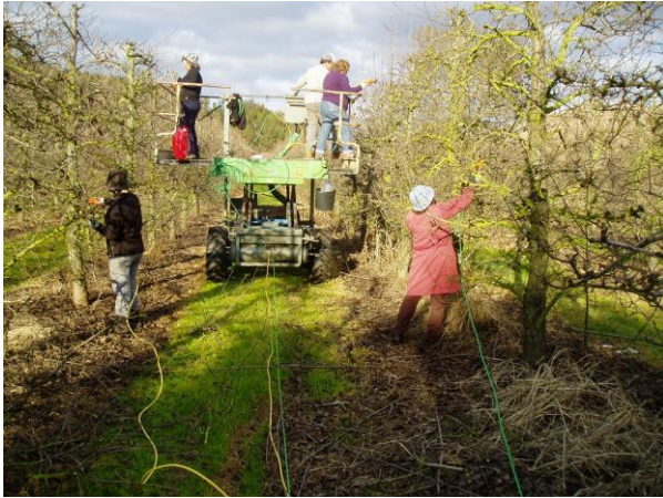
Figura 10 - Plataforma automotriz para poda manual com tesouras assistidas pneumáticamente
