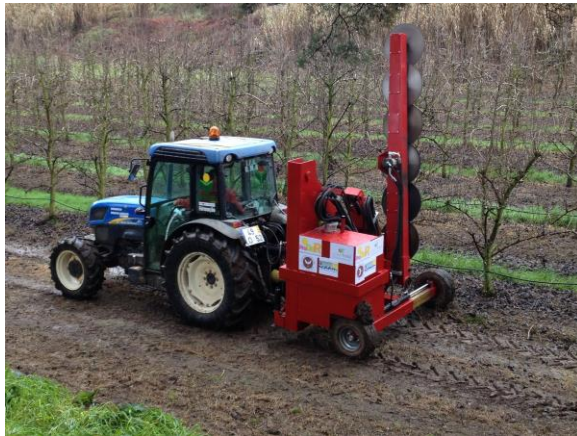
Figura 28 – Demonstração de poda com máquina de podar de discos em 17 de Janeiro de 2013 discos num pomar da Escola Profissional e Desenvolvimento Rural de Cister em Alcobaça
