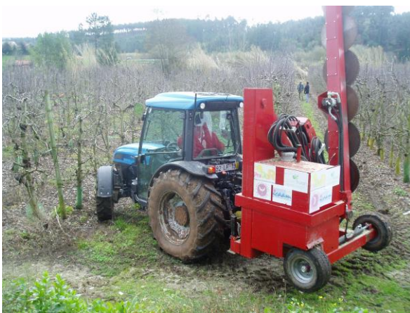
Figura 3 – Utilização do sistema de engate de três pontos do tractor nas manobras de cabeceira
