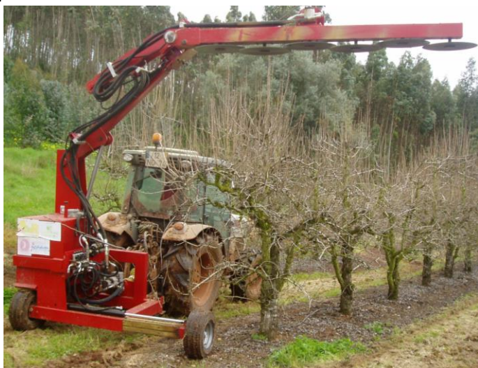
Figura 8 – Corte na horizontal com máquina de podar de discos
