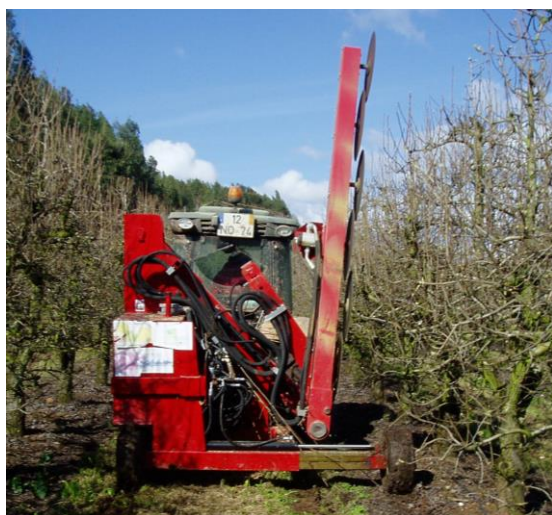
Figura 7 – Corte na vertical com máquina de podar de discos
